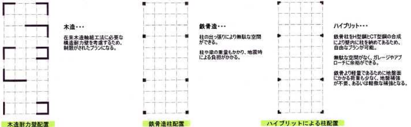
図2 ハイブリッド構造によるWS造の開発メリット
